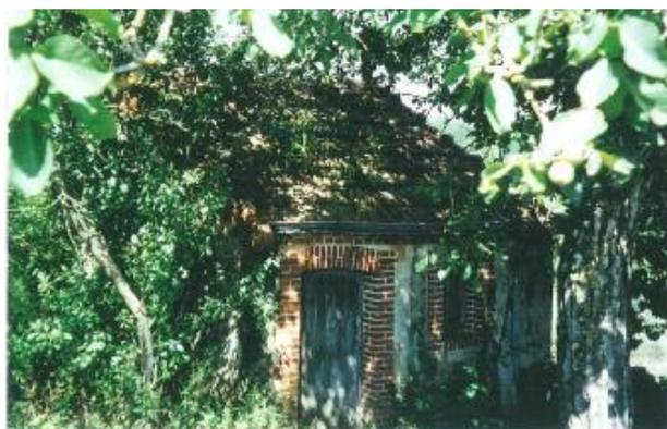
*Véritable maisonnette aménagée, manifestement encore occupée, sa porte en bois est fermée. Toit à un seul pan (unique dans la commune), constitué de grosses tuiles autobloquantes. Des briques rouges délimitent l'entrée et la fenêtre qui possède une vitre (voir photo face est). La cabane possède une gouttière métallique. L'édifice est visiblement hors d'eau et bien entretenu. Bien que très originale, sa structure globale s'apparente à la*
